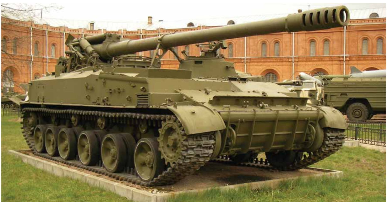
152 մմ տրամաչափի 2Մ5 «Գիացինտ» ինքնազնաց թնդանոթն Արցախյան գոյամարտի ընթացքում կիրառված ամենահեռահար հրետանային միջոցն է եղել:
