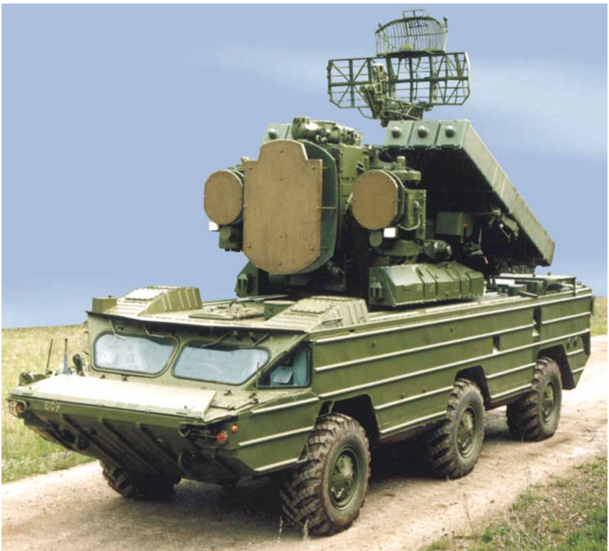
«ՕՍԱ-ՕԿ» ինքնագնաց զենիթահրթիռային համալիր (մինչև 10 կմ)
