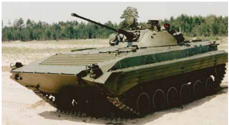
ԲՄՊ-2 տիպի ՀՄՄ: 30 մմ տրամաչափի արագաձիգ ավտոմատ հրանոթ ունեցող այս ՀՄՄ-ների կրակային հզորությունն այնքան մեծ էր, որ զրահատեխնիկայի պակաս զգացող Ինքնապաշտպանական ուժերի հրամանատարությունը նույնիսկ տանկերի պակասն էր փոխարինում հակառակորդից խլված ԲՄՊ-2-ներով:
